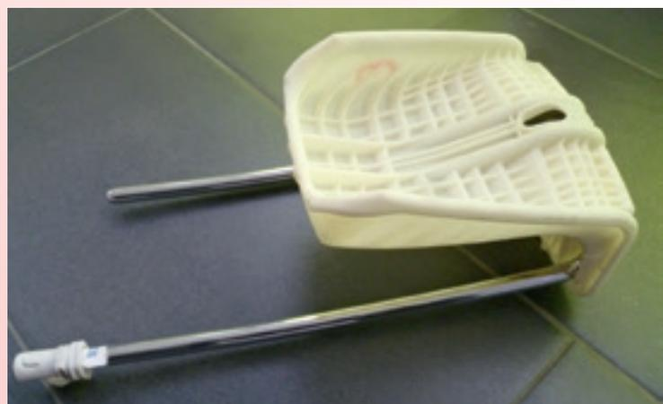
Ein von DeConPro entwickelter Kopfstützen- Prototyp für die Mercedes M- Klasse
