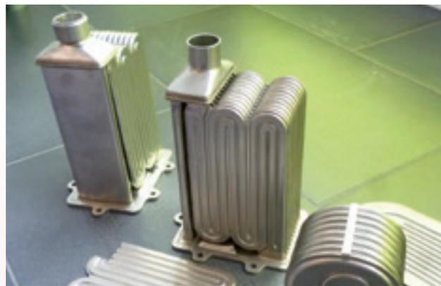
Einzelne unmontierte Kühllamellen, Vorseerienmodelle und endgültig fertige Prototypen der kommenden V6-TDI- AGR- Kühler
