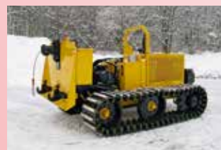
Die hydraulisch angetriebene Seilwinde zieht 4,3 Tonnen und das Heckschild lässt sich 50cm anheben und absenken.
