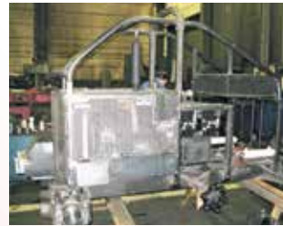
Chassisfertigung auf Stahlrohrrahmen, Motormontage und Anbringen der Hydraulikelemente in den Bremker Werkhallen
