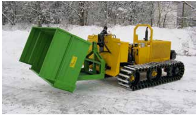
Die kippbare Metallbox für z.B. den Spundbohlen-transport auf moorastigen Böden in Sumpfgebieten ist optionales Zubehör
