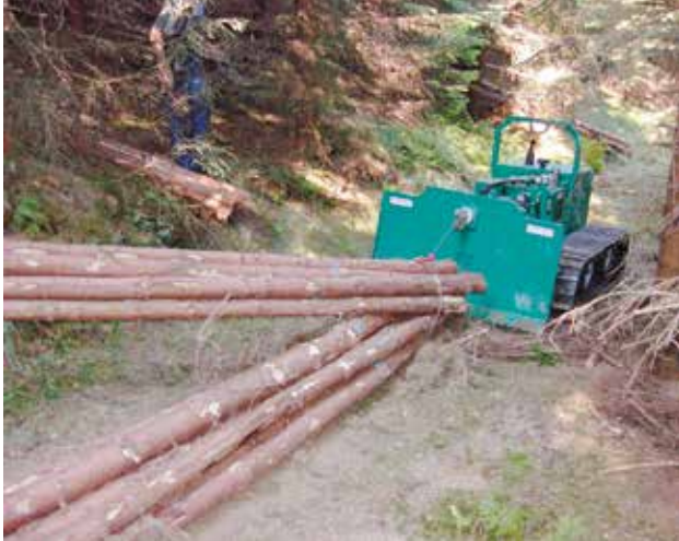
Die funkferngesteuerte Müller-Rückeraupe MRR bei einem Holzrückeeinsatz in einer engen Waldschneise
