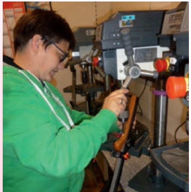
Löcher für den Sicherungsstift des Abzugshahn werden gebohrt
