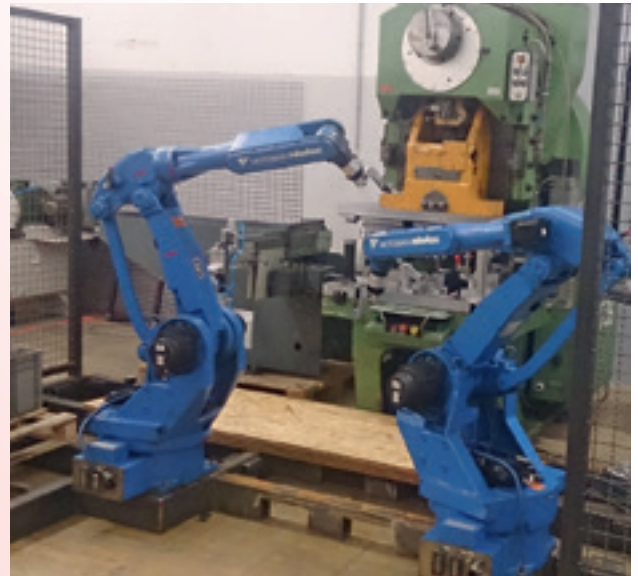
Eine ältere Exzenterpresse im Bestand wird mittels zweier 6- Achs- Roboter voll automatisiert.
