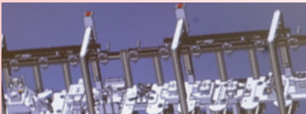
Die komplette automatische Fertigungsstraße für das Kopfstützen- Bauteil wird zunächst am PC mithilfe von CAD / CAM- Programmen geplant
