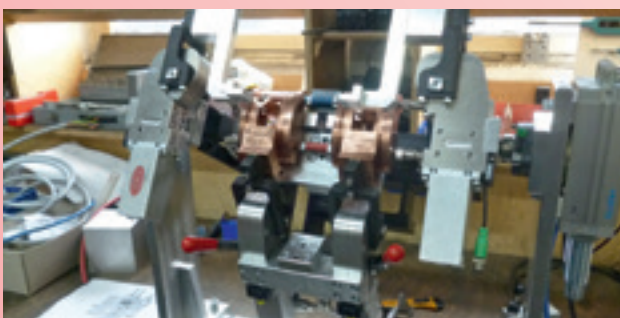
Ein Fahrerinnen- Klappscharnier für die Mercedes-LKW- Modellreihe „Actros“ wird demnächst mit diesem DeConPro- Schweißroboter gefertigt werden.
