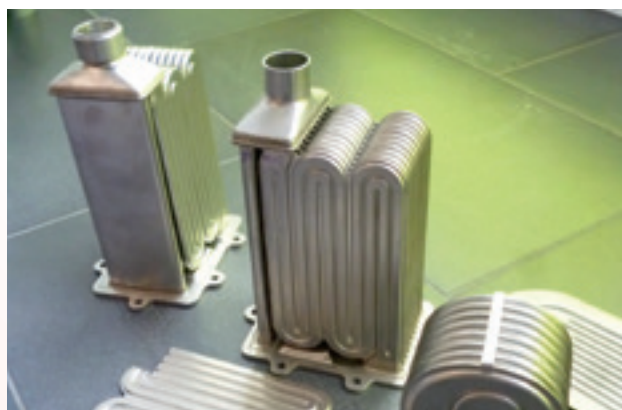
Einzelne unmontierte Kühllamellen, Vorserienmodelle und endgültig fertige Prototypen der kommenden V6- TDI- AGR- Kühler
